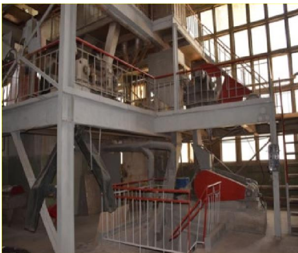
Рисунок 1 – Полупромышленные дробилки, работающие в замкнутом цикле с грохотом
