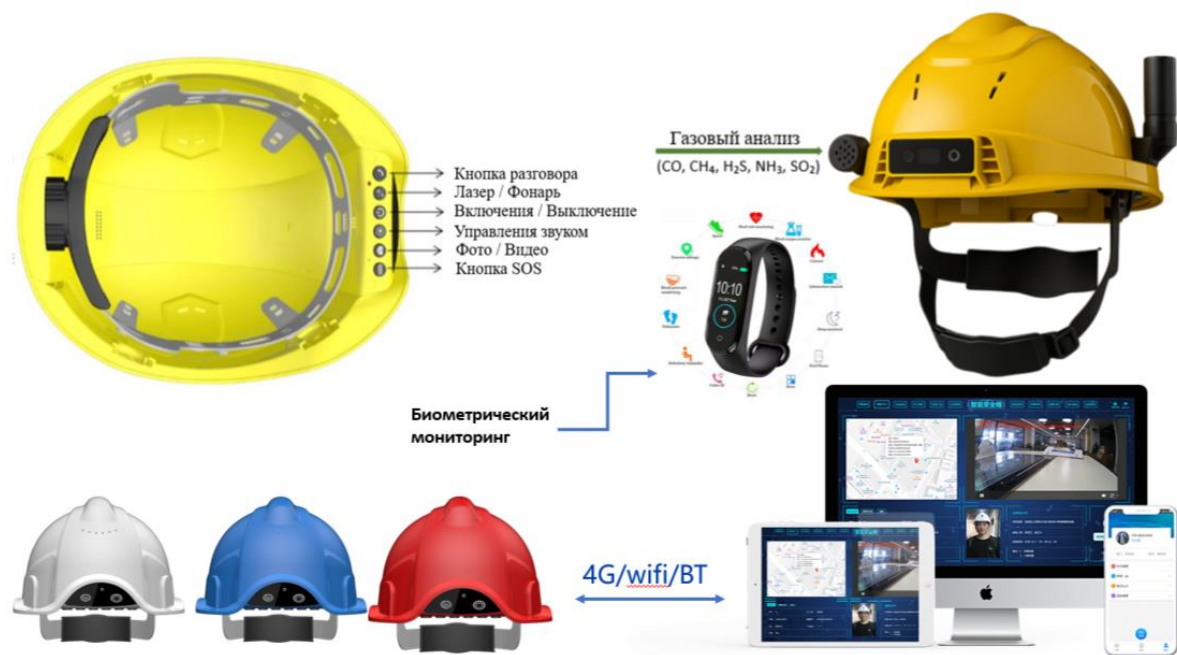
Рисунок 1 – Функциональная структура умной каски
