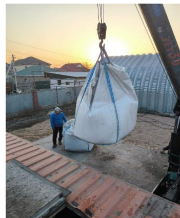
Рисунок 3 – а) схема водобоборты; б) загрузка пробы для проведения испытаний
