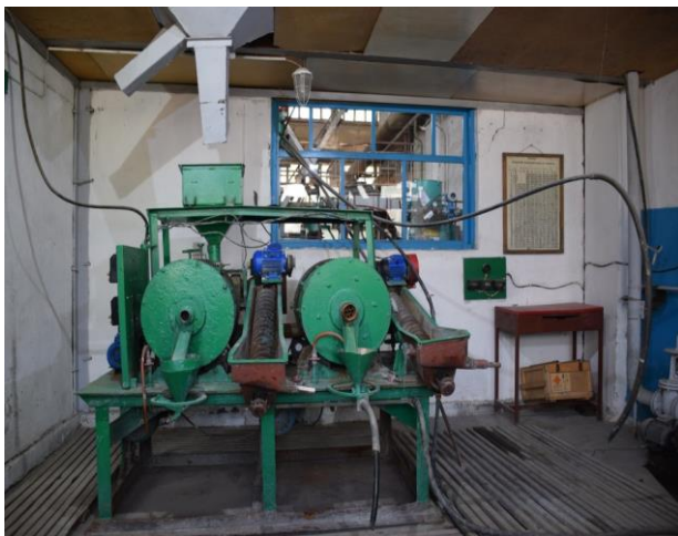
Рисунок 3 – Шаровые мельницы, работающие в замкнутом цикле со спиральными классификаторами
