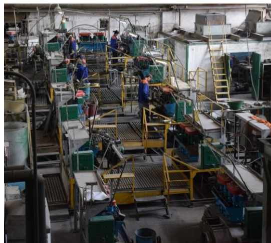
Рисунок 4 – Флотационное отделение полупромышленной установки
